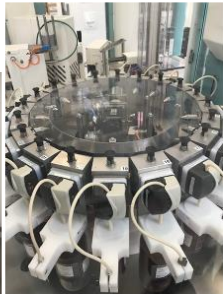
Vue rapprochée de l'automate et du système de distribution des gouttes
