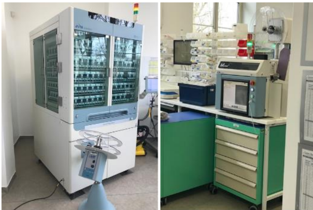
Automate pour les traitements par comprimés et écran de contrôle optique des erreurs
