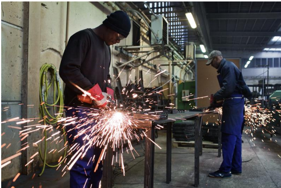
Absence de protection de la personne au deuxième plan dans l'atelier
